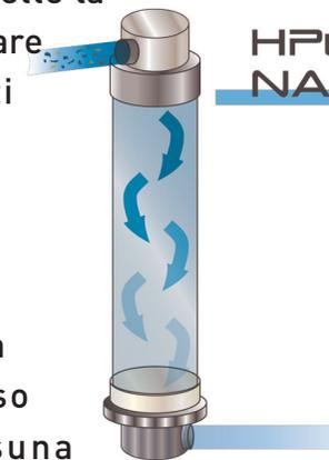
**HPure UF**, è una tecnologia a membrana utilizzata come barriera fisica che permette l'eliminazione della torbidità, dei virus e batteri rendendo l'acqua piovana adatta per un utilizzo tecnologico nell'ambiente domestico.
