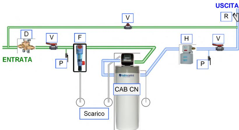
Lo schema d'installazione individua i componenti principali che devono essere installati per il corretto funzionamento dell'addolcitore.
