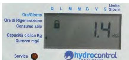
Il display visualizza la capacità ciclica dell'addolcitore espressa in kg di  $\text{CaCO}_3$ . Questo parametro viene utilizzato dal sistema per il calcolo del ciclo volumetrico dell'addolcitore.
